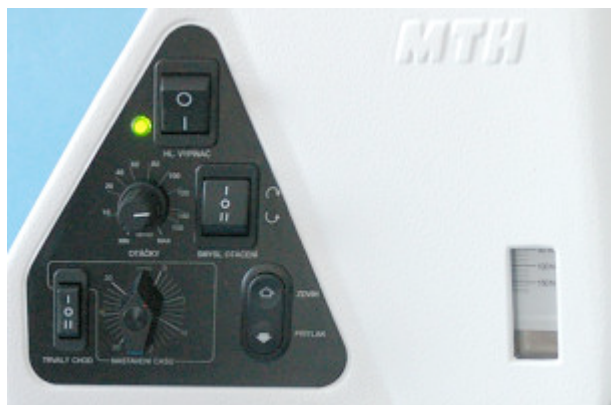
Ovládací panel a stupnice přítlaku nástavce APX 020
